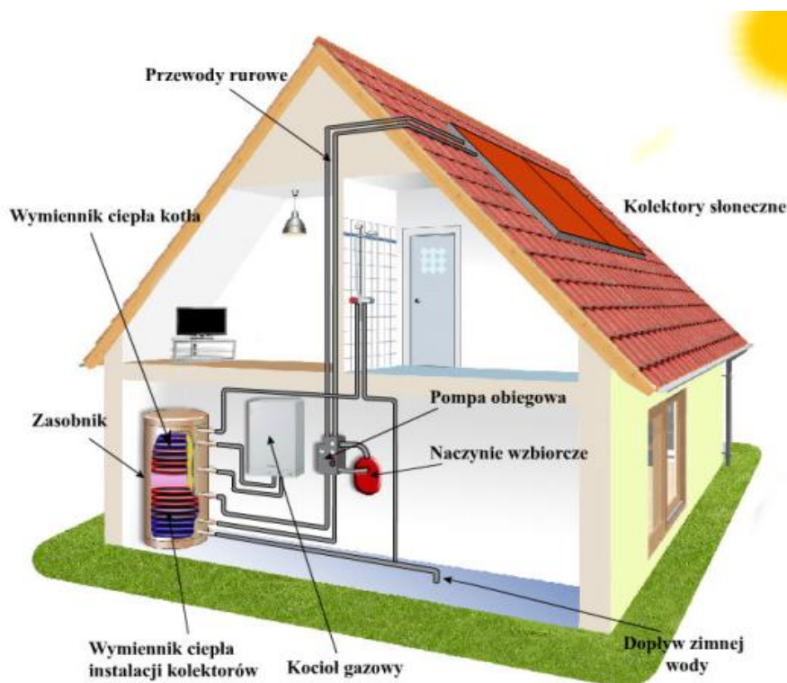
Ryc. 13. Schemat instalacji kolektorów słonecznych w domu jednorodzinnym
